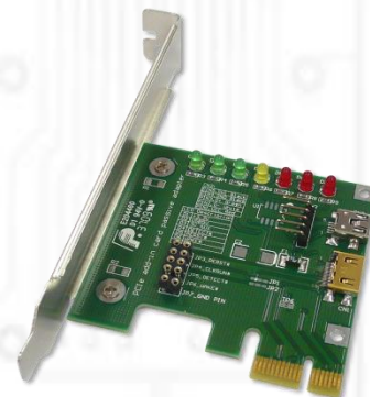
■ HP1A (PCIe X1 アダプタ) x1 ■ Y02-WH-015 (USB2.0 1x5 端子-1x5 端子ヘッダーケーブル) x1 ■ JP0156 (ロープロファイル PCIe プ ラケット) x1
